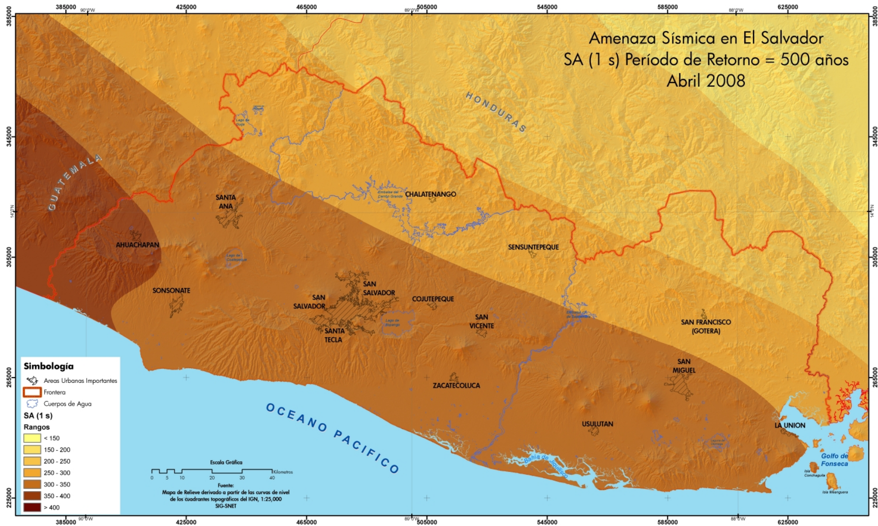
Figura 5.3 Mapa de amenaza sísmica de El Salvador en términos de SA (1.0s) expresada en gales para PR=500 años.
